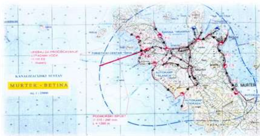
Slika 4. Kanalizacijski sustav Betina-Murter
